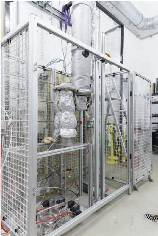
Le prototype mis au point au Laboratoire des processus durables et catalytiques de l'EPFL et développé par la société TreaTech permet de récupérer le phosphore des boues d'épuration. (Photo: © Alain Herzog)
